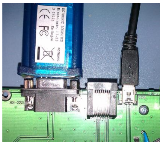
پنل IRIS را خاموش کرده و کابل ها را به شکل زیر به پنل متصل می کنیم.
