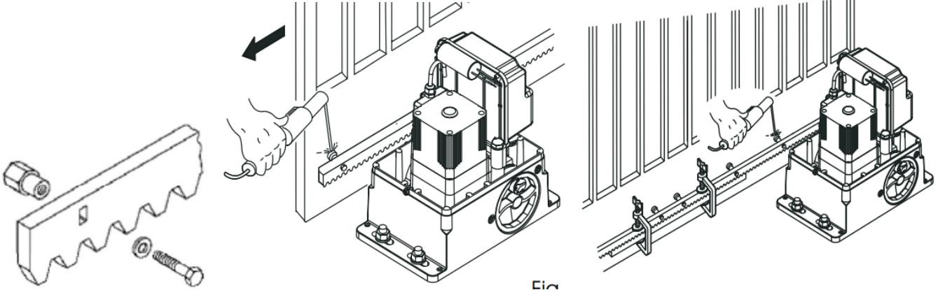
در هنگام نصب ریل، اطمینان حاصل نمایید که ریل ها در راستای هم قرار بگیرند و فاصله ۱,۵ میلی متری بین ریل و چرخende در تمام طول ریل رعایت گردد.
