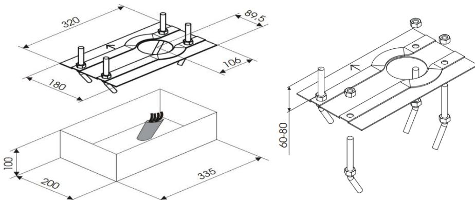
برای نصب دستگاه و ریل فواصل زیر رعایت شود. حداقل فاصله بین ریل (دندانه شانه ای) و چرخندنه مطابق شکل زیر در حدود ۱,۵ تا ۲ میلی متر باشد.
