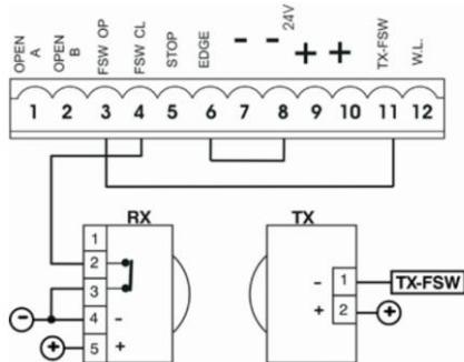
در صورتی که سیم کشی به درستی انجام شود LED های FSW OP و FSW CL و STOP و EDGE/SAFE باید روشن باشند.
