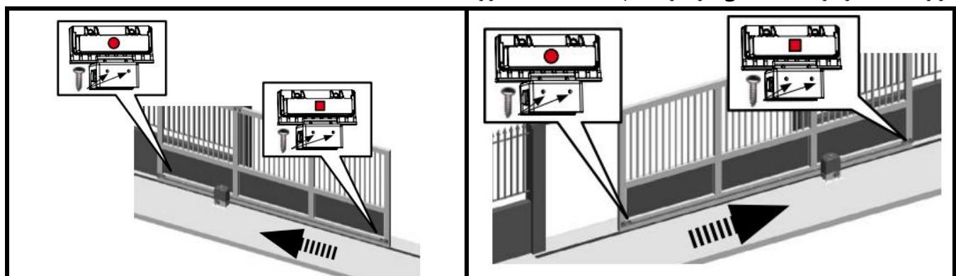
دستگاه را خلاص کنید و درب را با دست حرکت دهید، در صورتی که مگنتها به درستی متصل شده باشند در هنگام بسته بودن درب FCC خاموش و FCA روشن می باشد و در هنگام باز بودن درب FCC روشن و FCA خاموش می شود.
