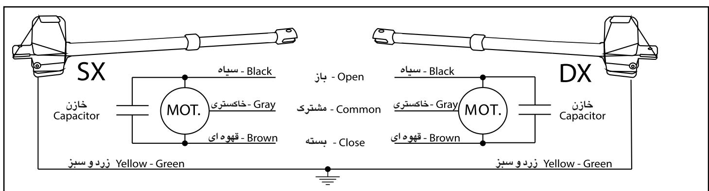
خازن‌ها را مطابق شکل به صورت موازی بین سیم‌ها باز و بسته قرار دادیم و چنانچه فاصله کنترل پنل با دستگاه زیاد باشد (بیش از ۱۰ متر) خازن‌ها را در یک باکس در نزدیکی بازو نگهداری نمائید
