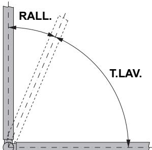
**ANMERKUNG:** bei befähigtem RALL (VERLANGS.) (dip 4 auf ON), wird der Gesamthub des Flügels von der Summe der in den beiden Trimmern eingestellten Zeiten gegeben (T.LAV. + RALL.) (BETRIEBSZEIT + VERLANGSAMUNG).
