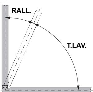
**NOTE : avec RALL activé (dip 4 sur ON), la course totale du vantail résulte de la somme des temps programmés sur les deux trimmers (T.LAV. + RALL.).**
