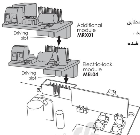
**نکته:** می توانید هر دو کارت اختیاری «MRX01, MEL04» را بر روی یکدیگر مطابق شکل مونتاژ کنید. فرقی نمی کند کدام کارت را ابتدا روی مرکز کنترل قرار می دهید. به جهت قرار گرفتن کارت ها بر روی مرکز کنترل، همانطور که در شکل نشان داده شده است توجه کنید. جهت شکاف کانکتورها به سمت داخلی مرکز کنترل باشد.
