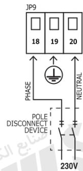
کلید قطع و وصل مناسب باید در مسیر سیم کشی قرار داده شود .
