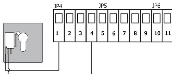
کنتاکت باز کلید سلکتور را به ترمینال های « 4 و 1 » روی بلوک ترمینال « JP4 » سیم کشی کنید .
