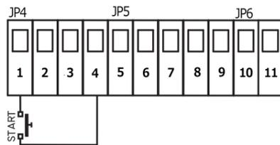
کلید کنترل استارت را به ترمینال های « 4 و 1 » روی بلوک ترمینال « JP4 » سیم کشی کنید . ( کنتاکت باز )
