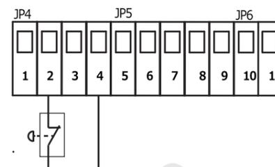
کلید اضطراری « STOP » را به ترمینال های « 2 و 4 » روی بلوک ترمینال « JP4 » سیم کشی کنید ( کنتاکت بسته ) کلید « STOP » اضافی را می توانید بصورت موازی به ترمینال های « 2 و 4 » وصل کنید. برای امنیت افراد و امکان توصیه می شود کلید « STOP » اضطراری را حتماً وصل کنید. ⚠
