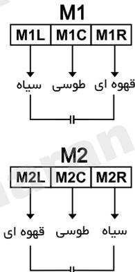
**موتور راست (M2):** اگر موتور را به گونه ای قرار دهید که برآمدگی موتور جک رو به پائین و بازوی جک به طرف راست باز شود، این موتور، موتور راست نامیده می شود که سیم بندی آن به ترمینالها مطابق شکل زیر است.
