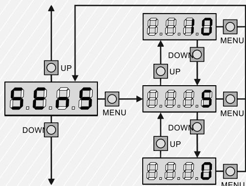
در طول مسیر حرکت جک ها در صورتیکه مانع در سر راه درب ها قرار گیرد ابتدا جک ها فشاری را به مانع اعمال کرده و در صورت ردنکردن آن متوقف خواهد شد. جهت تنظیم این حساسیت وارد گزینه **SEnS** می شویم. حساسیت از صفر تا ده قابل تنظیم است. هر چقدر به صفر نزدیکتر بشویم این حساسیت کم و هر چقدر به ده نزدیکتر بشویم این حساسیت زیاد تر می شود.
