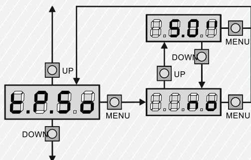
درب های در هنگام بسته شدن با یک سرعت مطلوبی حرکت می کنند. اگر با همان سرعت درب ها بسته شوند صدای بخوردی بین آنها اتفاق می افتد. برای برطرف کردن این مشکل می باشیست حرکت کندشونده در هنگام بسته شدن را تنظیم نماییم تا درب های در چند ثانیه آخر به آرامی بسته شوند. در حالت مطلوب آنرا روی ۴ ثانیه قرار دهید.
