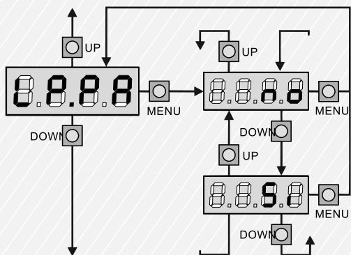
فلاشر همیشه در زمان حرکت درب ها چشمک می زند و در زمانیکه درب باز مانده چشمک زدن آن متوقف می گردد. با ورود به گزینه **LPPA** و تنظیم آن روی حالت **Si** فلاشیر در زمان بازماندن درب هم چشمک خواهد زد.
